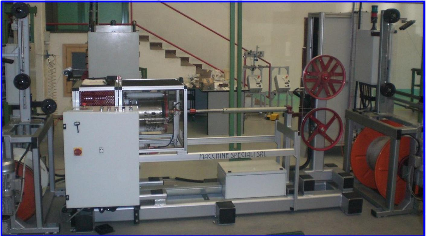
Die Anlage besteht aus Ablaeufen, einem konzentrischen Bandierkopf, einer Abzugsscheibe und einem Aufwickler. Sie kann fuer die Bebaenderung von Kabel bis 10 mm Durchmesser eingesetzt werden. Die gesamte Anlage ist ueberwacht durch digital Bus zur Synchronisierung von allen Motoren und Antrieben. Alle Zugparameter des Bandes koennen mit einstellbaren Rezepten am Touchscreen gehandhabt werden.
